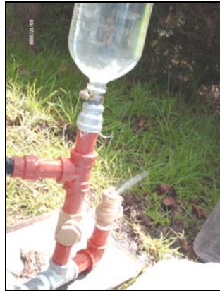
Figura 01. Modelo del ariete terminado
